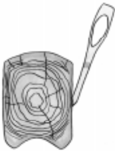
Modell 1900 (häufigst) Doppelseitiger Anschlag für allerlei Beilarbeiten an Stämmen, Planken, Eckverbindungen u.dgl. "Haubeil"
