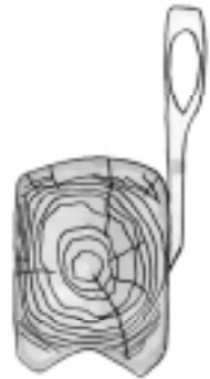
Modell 1900 Gewöhnlicher Scherenanschiff für Kantarbeit am Holz entlang "Kantbeil"
