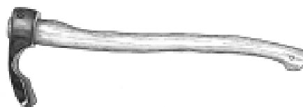
Dechsel Schneidenlänge: 7 cm Gewicht mit Stiel: 1,2 kg Stiellänge: 65 cm
