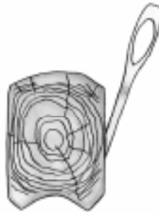
Modell 1900 Umgekehrter Scheren- anschiff. Zum Bebeilen von gezimmerten Wänden. Macht die Ecken leichter zugänglich und ergibt ein Wellenmuster "Beil zum Behauen"
