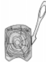
Modell 1700 und Modell 1800 Doppelseitiger Anschliff zum Beilen von Stämmen, Planken und für Eckverbindungsarbeiten
